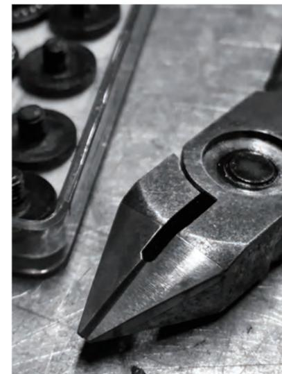
精密ニッパーとして、結合部にベアリングを使用し、ガタのないスムーズな可動と精巧な刃先のかみ合わせを実現しました。刃部は耐磨耗性に優れた独自の超硬刃を採用し、ピアノ線、タングステン細線、硬鋼線などの切断に適しており、精密機器などの製造工場や歯科医療などの現場で幅広く使用されています。
